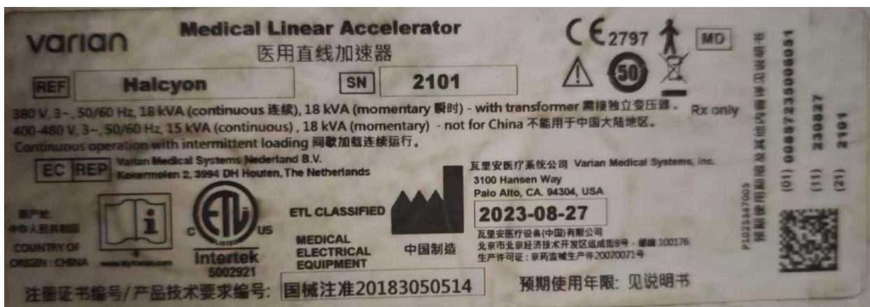
图 2-6 本项目 Halcyon 型医用电子直线加速器及其铭牌
