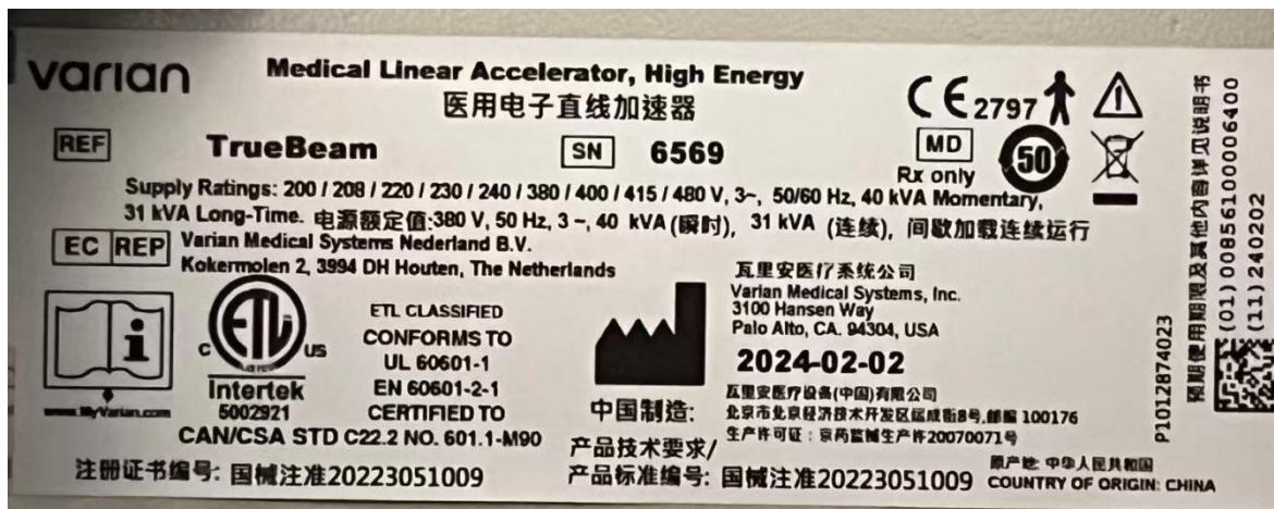
图 2-7 本项目 TrueBeam 型医用电子直线加速器及其铭牌
