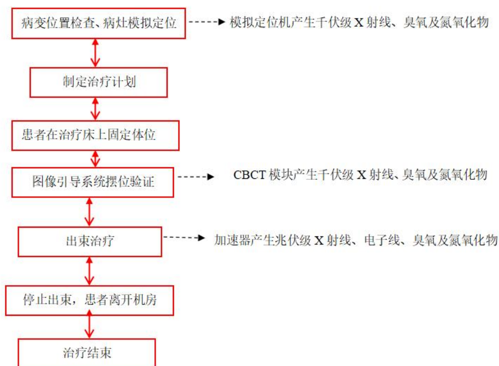
图 2-9 加速器治疗工作流程及产污环节示意图
